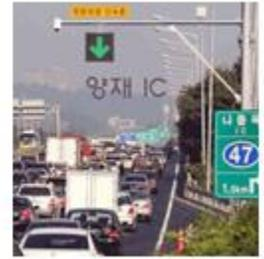
고속도로 갓길에 LCS (가변 차선 제어) 시스템을 구축, VMS (도로 전광판 시스템) 및 CCTV 와 연동하여 출퇴근 시간대 및 교통량 증가에 따라 갓길의 진출입을 허용, 원활한 차량흐름과 지체 및 정체를 해소하는 시스템입니다.
